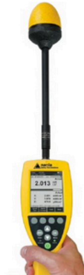
Mesureur avec sa sonde de champ électrique (100 kHz – 6 GHz)
